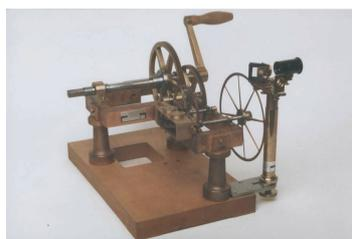
FIGURE 5 Dispositif de Fizeau permettant de mesurer la vitesse de la lumière. (© AG Didaktik und Geschichte der Physik, Universität Oldenburg)
