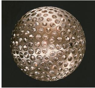
**FIGURE 57** Les satellites LAGEOS : des sphères métalliques d'un diamètre de 60 cm, d'une masse de 407 kg, recouvertes de 426 rétro-rélecteurs. (NASA)
